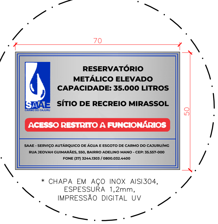
DETALHE C PLACA DE IDENTIFICAÇÃO ESC. 1:10
